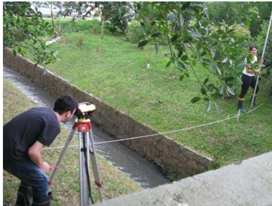
Figura 7. Bolsistas do projeto determinando a seção do canal e da área de inundação no ponto P2
