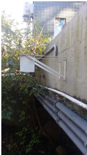
Figura 12. Suporte de Sensor Ultrassônico (P2)
