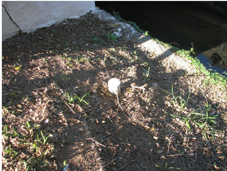
Figura 3. RN instalado no ponto de monitoramento número 3.
