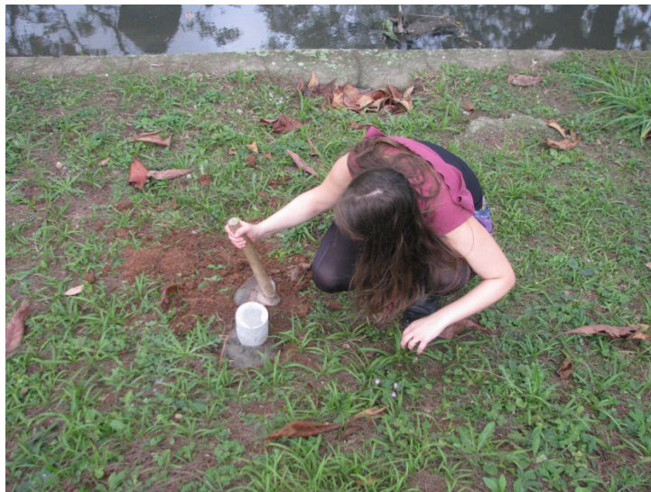
Figura 2. Instalação de RN no ponto de monitoramento número 1.
