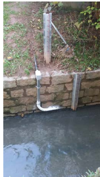
Figura 13. Suporte para sensor de turbidez
